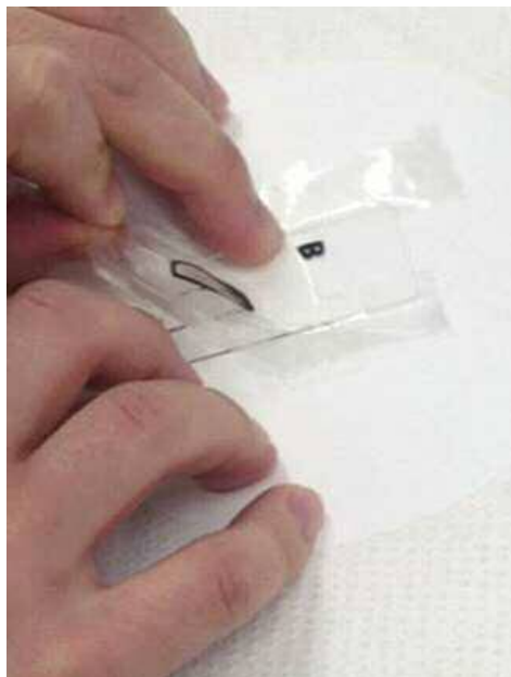
写真2 PVA 膜にマジックで灰化残渣の輪郭を記してから、剥がす。
