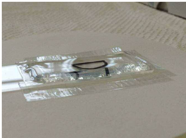
写真1 PVA 水溶液塗布後の様子
